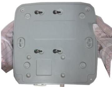
④ Drehen Sie die Oberseite des Gerätes nach unten, und drehen Sie die Schrauben fest ein.
