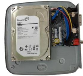
③ Richten Sie die Festplatte mit den vier Bohrungen im Boden aus.
