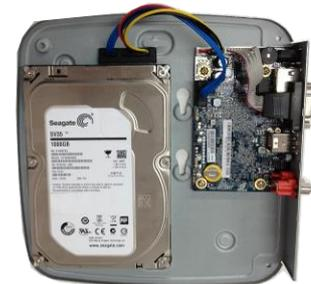
⑥ Verbinden Sie das Festplattenkabel und Netzkabel.
