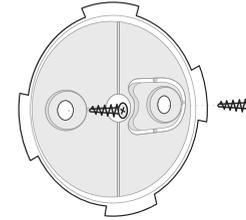
2. Die Sirene auf die Platte „SmartBracket“ aufsetzen und im Uhrzeigersinn drehen, das Blinken der Leuchtdiode bestätigt, dass der Sabotagekontakt aktiviert wurde.
