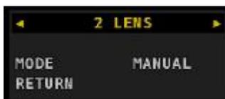
Kameras VCHD-2622, VCHD-4322IR und VCHD-2792IR sind mit einem fest installierten, DC-gesteuerten Objektiv ausgestattet. Daher muss die ObjektivEinstellung auf „DC“ stehen.
