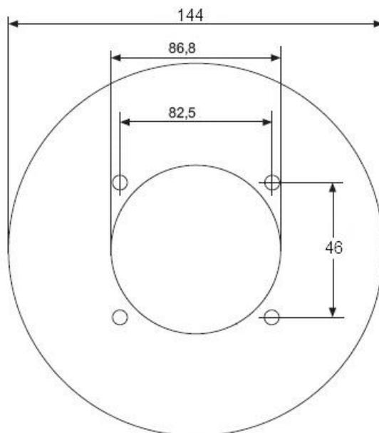
**Aufputzmontage: Unterseite / Surface mount: Bottom view:**
