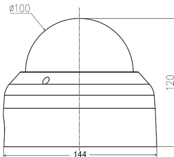
**Unterputzmontage: Unterseite / Flush mount: Bottom view:**
