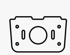
Punti di fissaggio preforati sia per la telecamera che per la staffa
