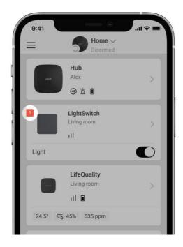
Wenn das Gerät eine Störung feststellt (z. B. keine Verbindung mit der Hub-Zentrale), zeigt die Ajax-App einen Störungszähler im Gerätefeld an.
