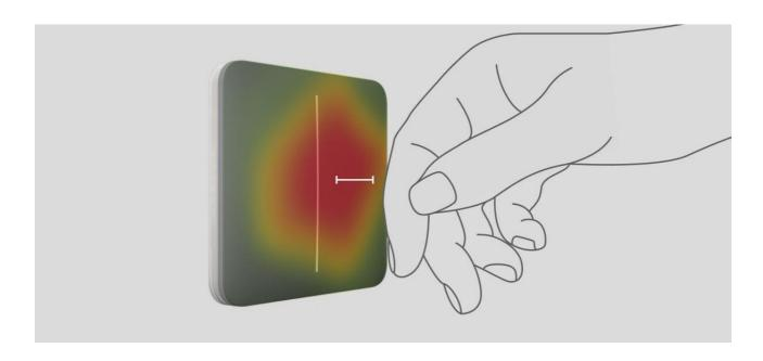
Mit LightSwitch können Sie die Beleuchtung steuern, indem Sie einfach Ihre Hand 15 mm vom Schalter entfernt halten oder das Touch-Panel des Schalters berühren. Die berührungslose Steuerung ermöglicht es, den Schalter auch mit schmutzigen oder nassen Händen ein- oder auszuschalten. Der Sensor reagiert unter allen Bedingungen. Daher kann der Schalter an überfüllten Orten installiert werden: in Restaurants, Fabriken und Büros.
