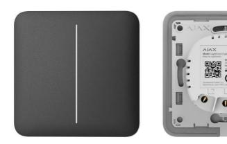
Ein einzelner LightSwitch besteht aus zwei Elementen: einem **LightCore**-Relais und einem **SoloButton**-Touch-Panel.
