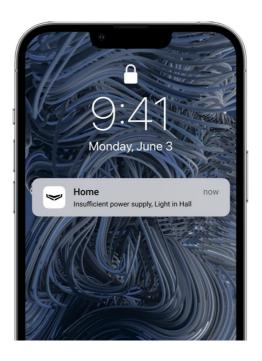
LightSwitch misst regelmäßig den Schaltstrom. Wenn LightSwitch die Stromversorgung eines Beleuchtungsgeräts mit unzureichender Leistung (bis zu 5 W) steuert, benachrichtigt das System die Benutzer des Ajax-Systems. In diesem Fall ist es notwendig, das Beleuchtungsgerät durch ein ähnliches Gerät mit höherer Leistung zu ersetzen oder den mitgelieferten Kondensator parallel zum Beleuchtungsgerät anzuschließen.
