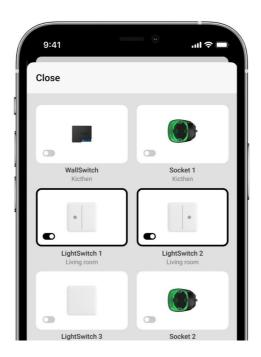
Die Beleuchtung kann auch im **Fernbedienung**-Menü • gesteuert werden. Gehen Sie dazu zum **Fernbedienung**-Menü • und wischen Sie nach oben. Alle der Hub-Zentrale hinzugefügten Steuergeräte werden in der Liste angezeigt. Klicken Sie auf den Umschalter im **LightSwitch**-Feld und der Status der Gerätekontakte kehrt sich um. Die Beleuchtung schaltet sich ein oder aus.
