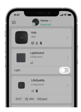
Durch Drücken des Umschalters im **LightSwitch**-Feld im **Geräte**-Menü in der Ajax-App wird der Zustand der Schaltkontakte geändert; die Beleuchtung wird ein- oder ausgeschaltet. Auf diese Weise können Systembenutzer die
