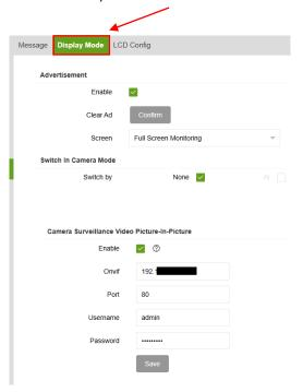
Jetzt lassen sich bei **Camera Surveillance Video im Picture-in-Picture-Modus** die IP-Adresse sowie die Login-Daten der externen Kamera eintragen. Vergewissern Sie sich, dass das ONVIF-Protokoll in der Kamera selbst aktiviert ist.
